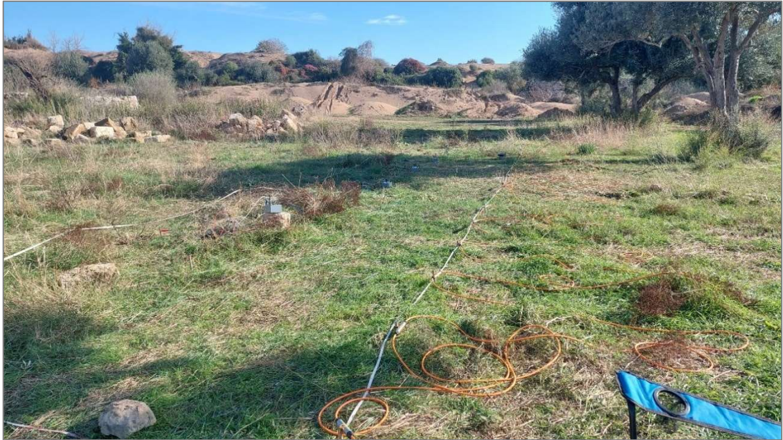
Şekil 4.6 Kablosuz alıcılar ve çok elektrotlu sistemin ölçümler sırasındaki görünümü
