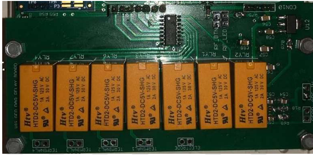
Şekil 2.6 Elektrot yönetimi için geliştirilen röle kartı
